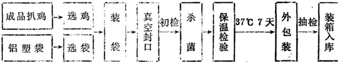
由上图可见：软包装扒鸡系流水作业加工而成，工艺合理。生产厂卫生制度严格，所用设备、容器、车间空气定时消毒。工人操作前严格洗手，尽量减少扒鸡装袋前的污染。杀菌时软包装扒鸡在杀菌釜内单层排放，杀菌后向杀菌釜内注反压水使软包装迅
